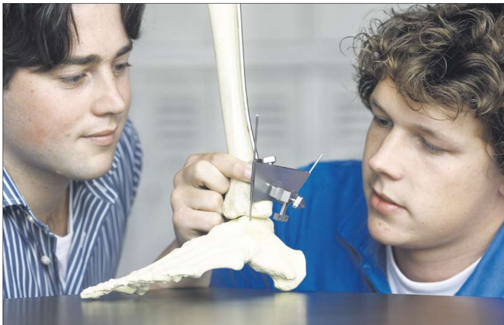
Nauwkeurig enkels doorzagen is een vak apart. Pieter-Bas Wulms en Mathijs de Wit ontwikkelden speciaal hiervoor een zaaggeleider. (Foto's: Sam Rentmeester/FMAX)
